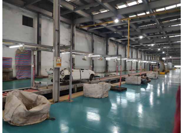
图表 10：华仁汽车拆解线
